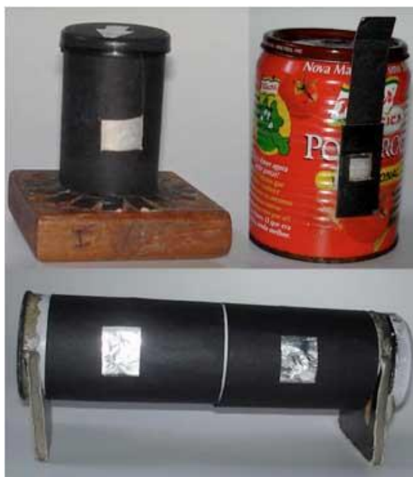
Figura 1 - câmeras pinhole de um e dois orifícios utilizadas por Tayana e Jefferson.
